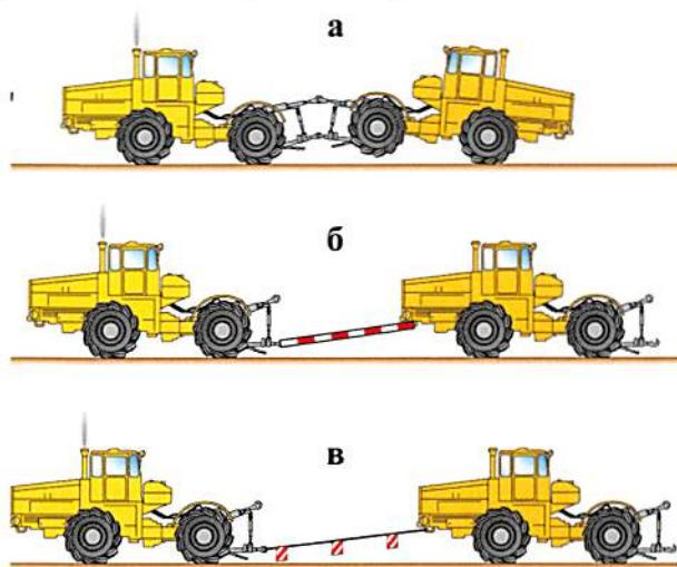
1. Приподняв гидросистемой заднюю часть трактора и соединив их пневмоприводом (a).
