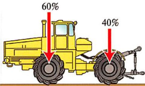
1. При работе с сельхозмашинами нагрузка между мостами перераспределяется до соотношения 50x50%.
