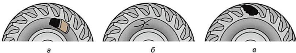
1. Шина имеет сквозной разрыв (*a*).
