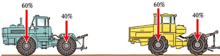
1. При работе с сельхозмашинами нагрузка между мостами перераспределяется до соотношения 50x50.
