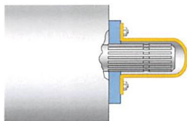
1. На хвостовик должен быть установлен кожух.
