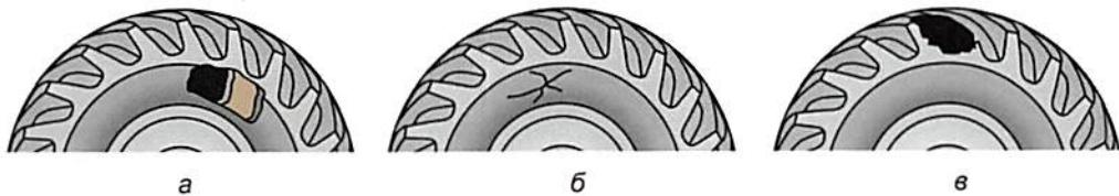
1. Шина имеет сквозной разрыв (вариант *a*).
