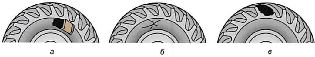
1. Шина имеет сквозной разрыв (вариант а).
